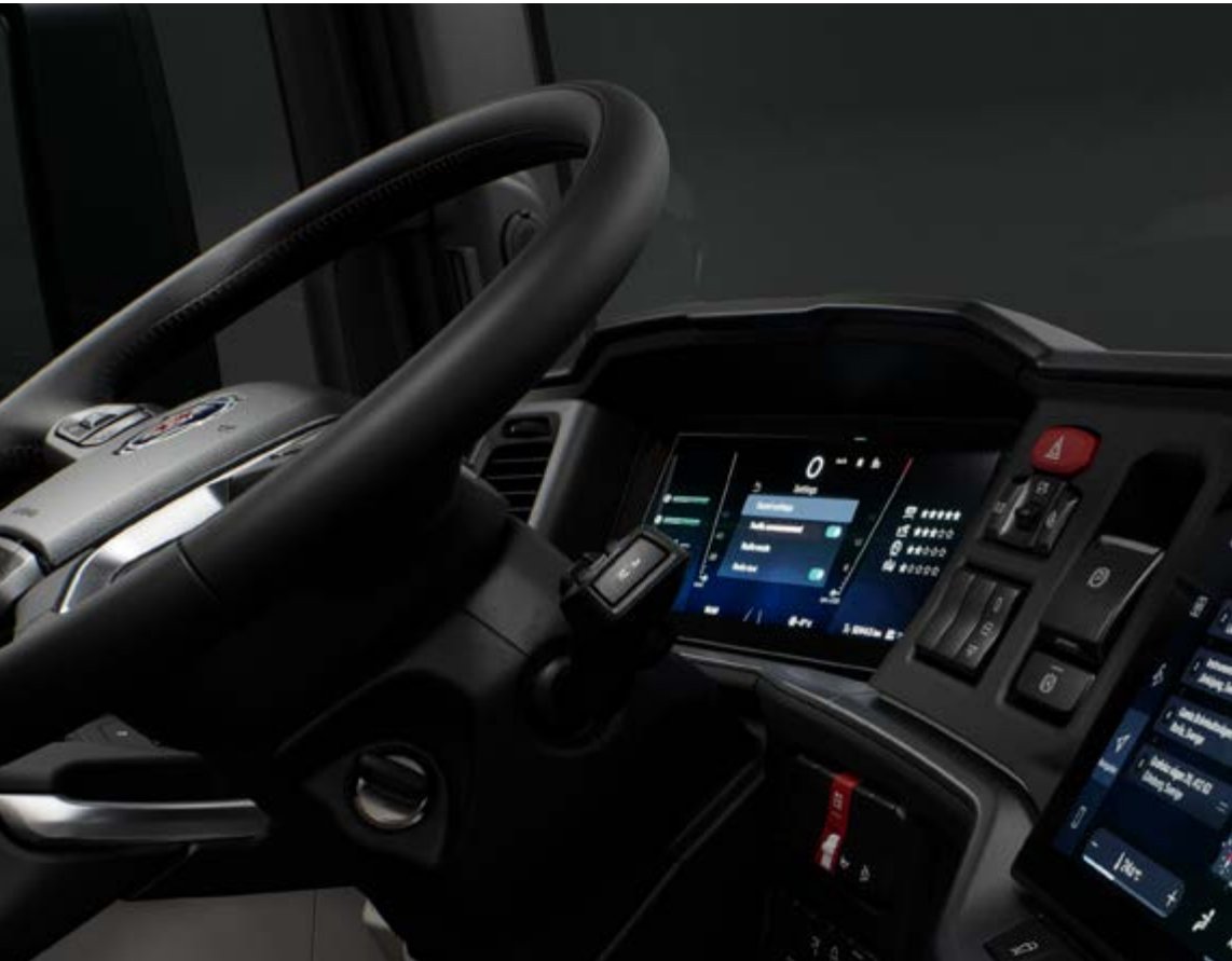
Instrument combiné Clair et distinct, avec toutes les informations essentielles facilement contrôlées et commandées : l'instrument combiné Scania affiche les informations à l'attention du conducteur à l'aide de signaux visuels et sonores.
