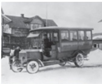
Den så kallade "Nordmarksbussen" var den första helt svenskbyggda bussen. Bussen byggdes av Scania i Malmö 1911 på ett lastbilschassi. Den försågs med motor och kaross hos Vabis i Södertälje.
