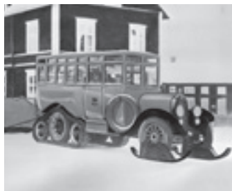
Motordrivna fordon hade svårt att göra sig gällande i vinterväglag. I samarbete med Postverket konstruerade Scania-Vabis femton motordrilligenser (1922–23). De första var försedda med banddrift och medar framtill för att för att kunna utnyttjas när vägen var helt snötäckt.
