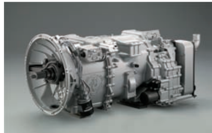
Scanias nya växellådsprogram är uppbyggt av moduler.
