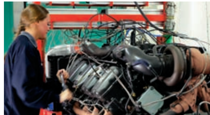
Scania har ett 40-tal provceller där motorer testas vad gäller prestanda och emissioner.
